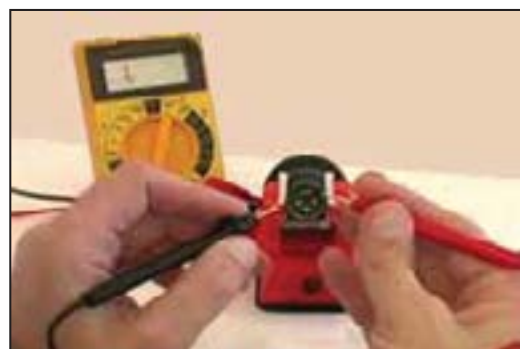
Fig: 3.3.10.4.2 Testing of Mic.
